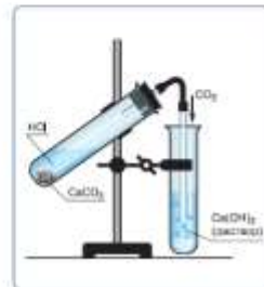
Рис. 114. Прибор для получения углекислого газа
