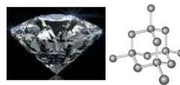
Рис. 15. Кристалл алмаза С (слева) и модель его кристаллической решётки
